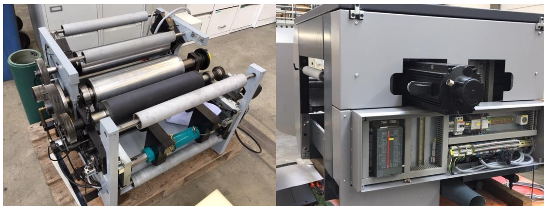
Voorbeeld van een Extension, te weten een Flexomodule voor het lakken en coaten van materialen.
